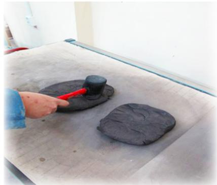
Глина разминается и раскатывается на раскаточном столе в пласт нужной толщины.
